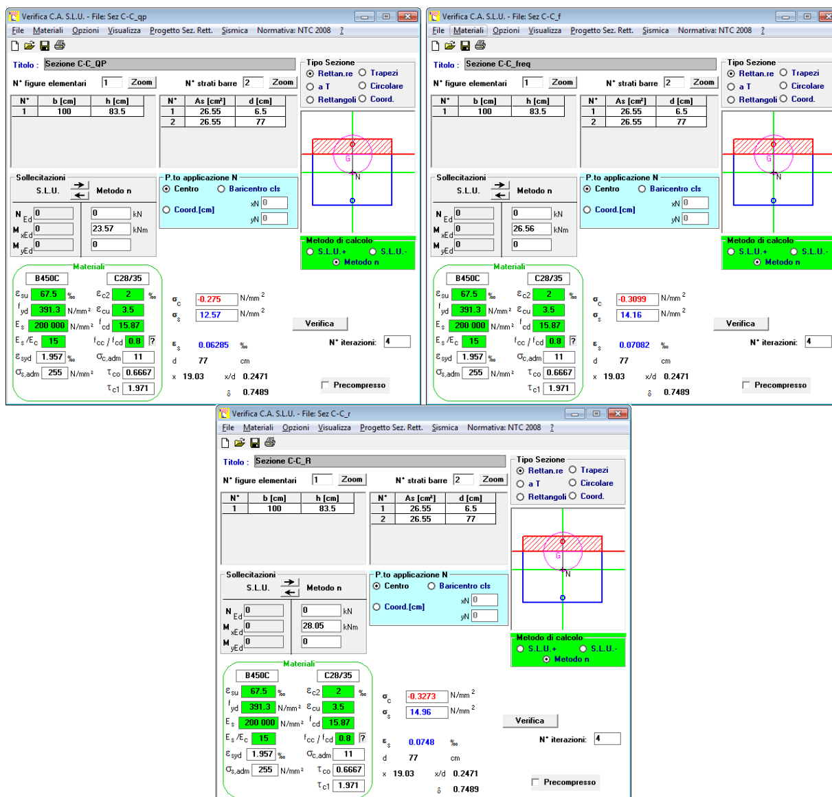
Figura 6-17: Fondazione sbalzo di valle Sez C-C - Calcolo delle tensioni in Combinazione SLE Quasi permanente, Frequente e Rara.
