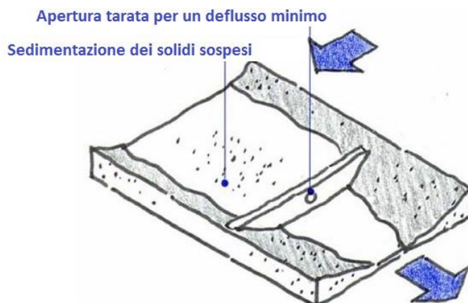
Figura 4-1: Esempio del funzionamento dei fossi inerbiti con funzione di laminazione
