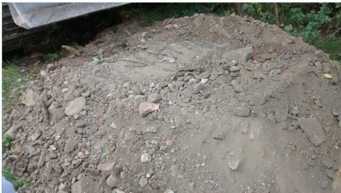
Figura 9-2: Terreno scavato durante la prova di carico su piastra TP1 e corrispondente allo strato di riporto (Rip)
