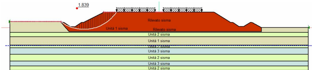
Figura 15-15: Stabilità globale in condizioni sismiche +.
