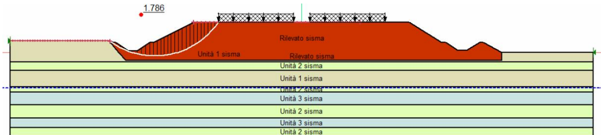
Figura 15-16: Stabilità globale in condizioni sismiche -.
