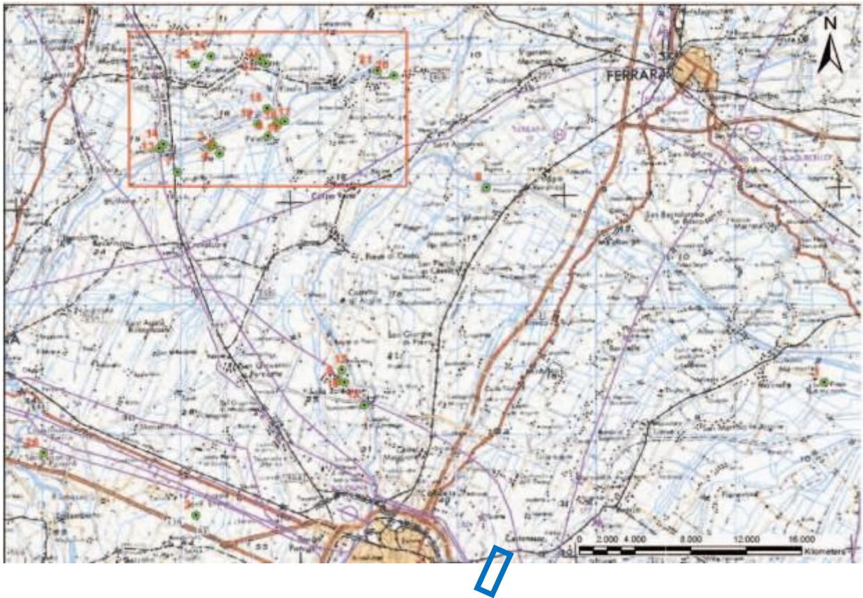
Fig. 17b - Ubicazione Sinkhole area nord di Bologna; in verde i punti in cui si sono registrati fenomeni di sprofondamento ed in blu l'area di intervento.
