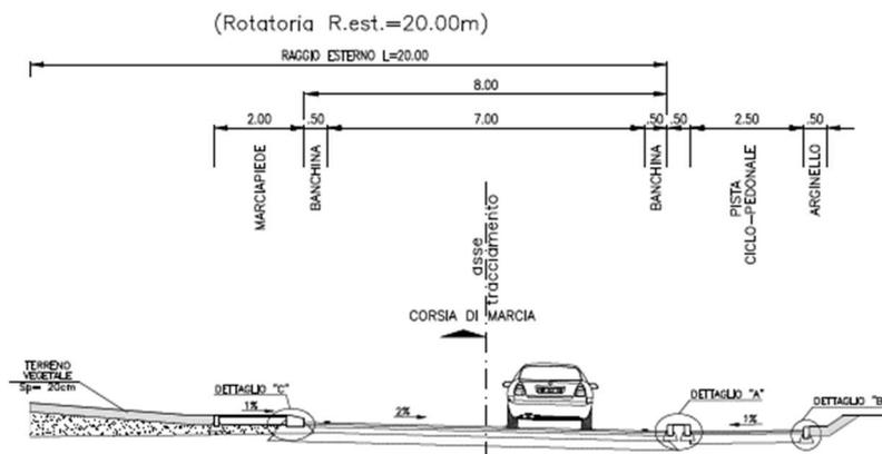
intervento 3: sezione tipo rotatoria SP4 – Via Marconi
