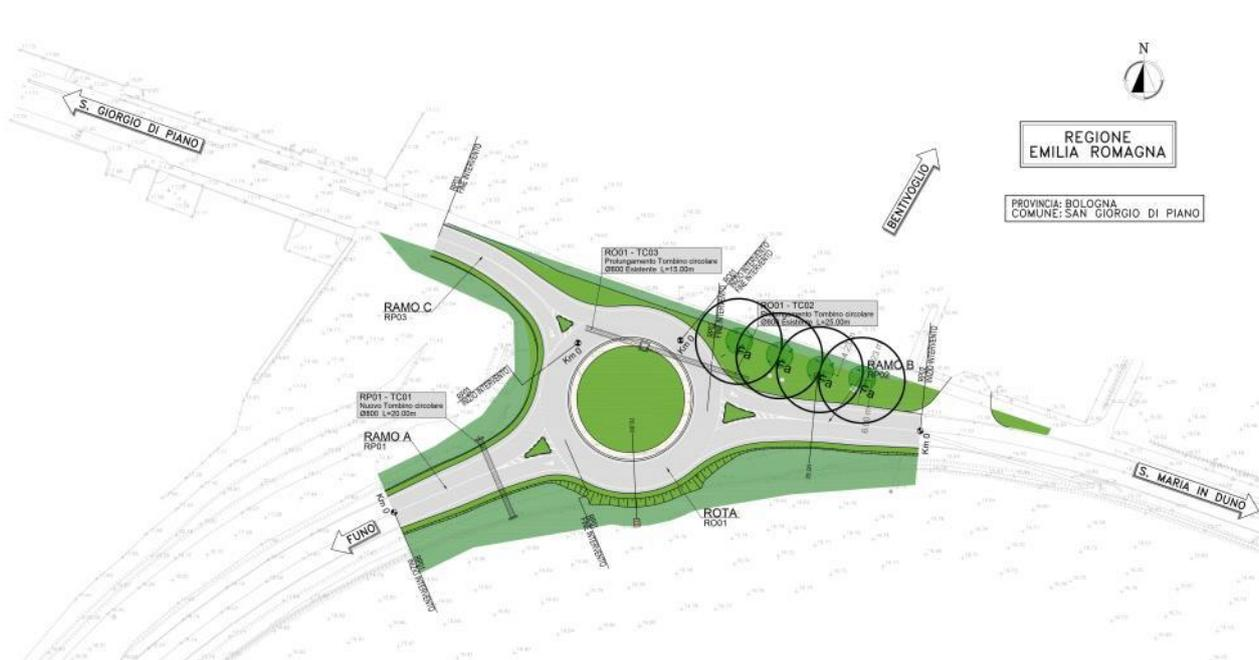
L'ultima area di intervento prevede la realizzazione di un'ampia rotatoria a tre uscite al posto dell'attuale intersezione, con contestuale necessaria realizzazione di isole di traffico e revisione dei profili esistenti.
