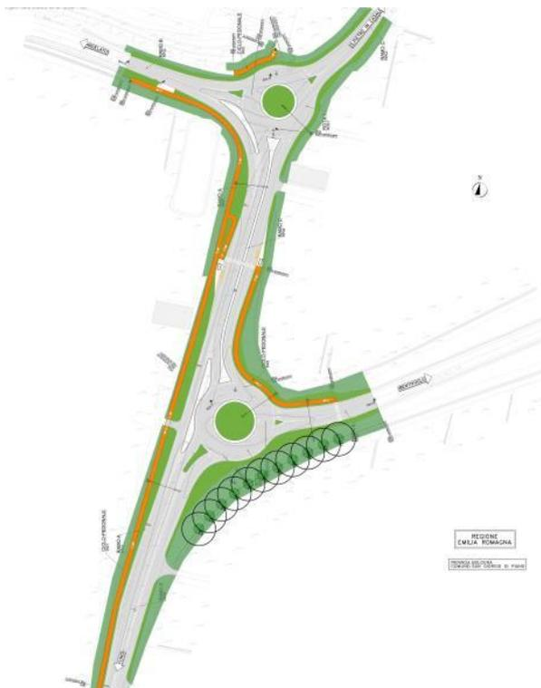
Nell'area di intervento 2, come descritto nei precedenti paragrafi, è prevista la realizzazione di due rotatorie sulla S.P.4., entrambe a tre uscite. Una ulteriore corsia manterrà l'andamento Nord-Sud senza consentire l'immissione in rotonda. A Est e Ovest della carreggiata verranno realizzati due nuovi tratti di ciclabile.
