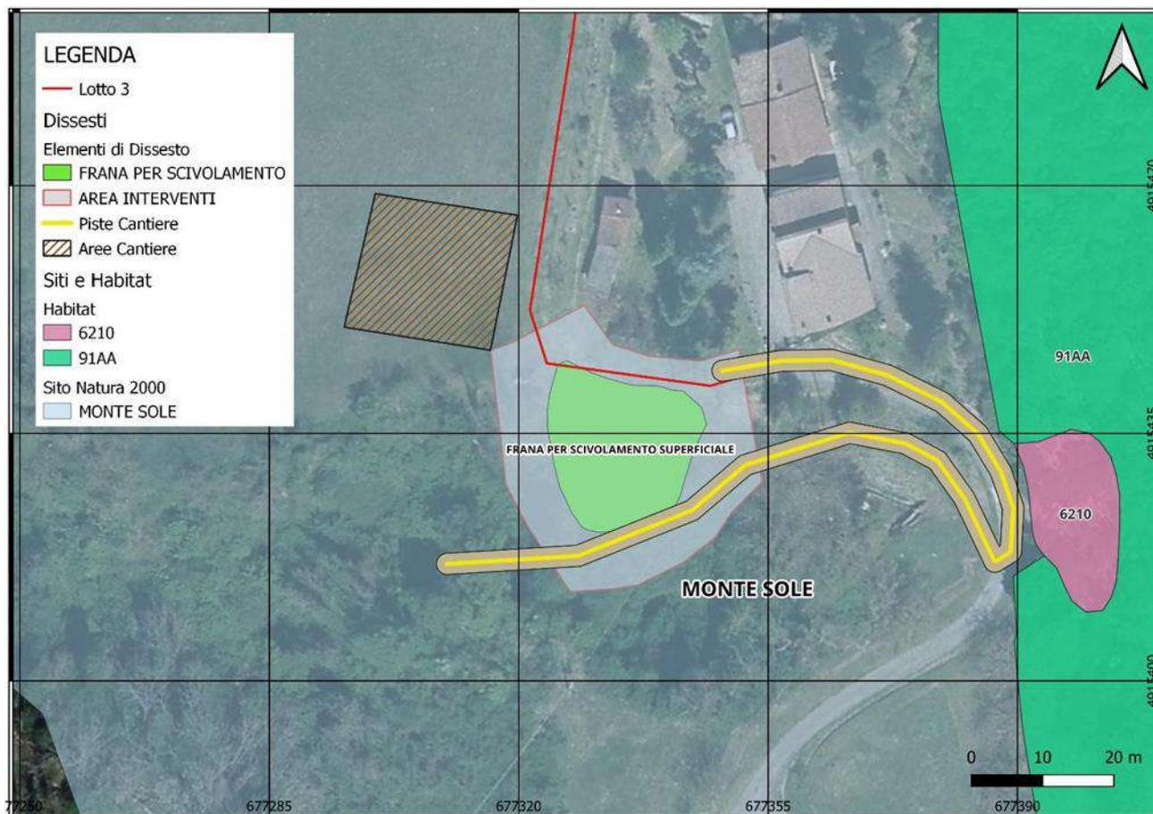
Gli interventi per la messa in sicurezza sono: disboscamento, scotico di 0.5 metri del tratto stradale e 0.3 metri del versante, installazione di chiodature, geocomposito, reti e funi di acciaio. La pista di cantiere in parte coincide con la strada sterrata esistente, il tratto di nuova pista di cantiere ha una lunghezza di 15 metri circa. Considerando una larghezza di 4 metri, la superficie di pista da disboscare risulta di 60 metri quadrati.
