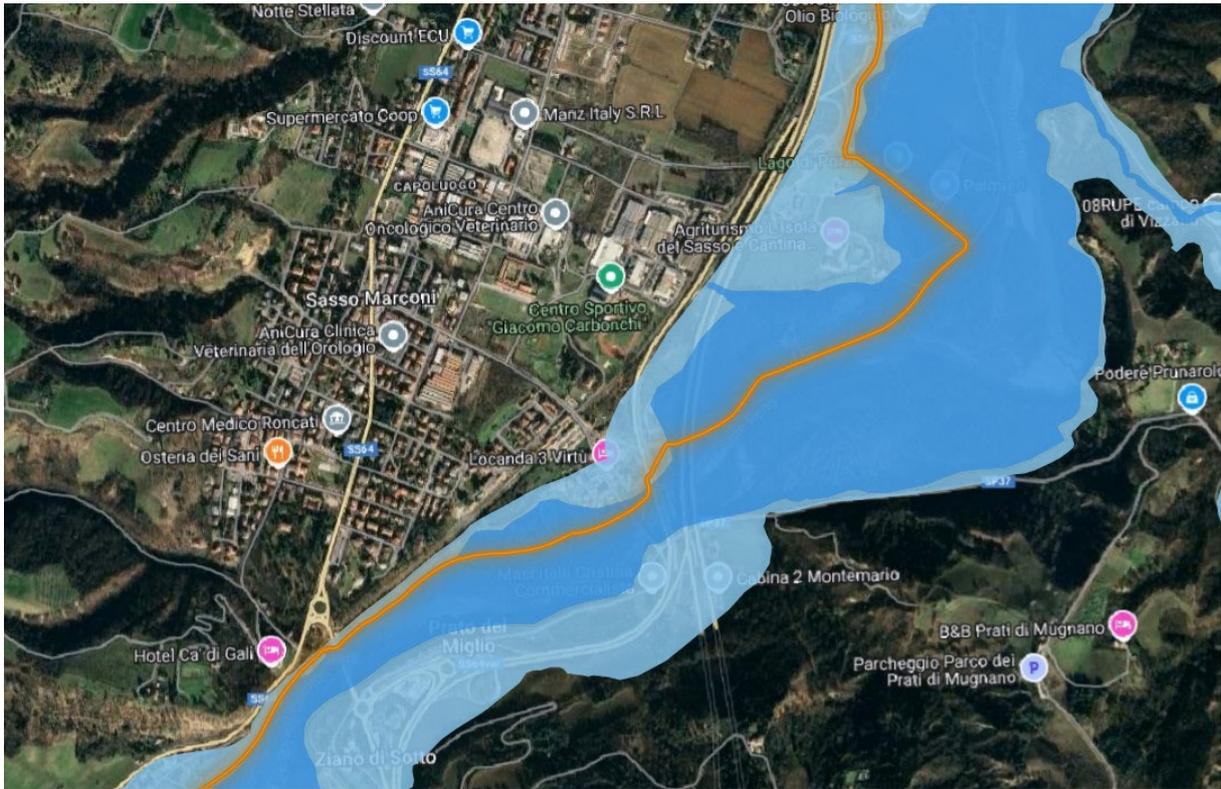
Figura 2 Sovrapposizione del tracciato alle aree di pericolosità del PGRA in corrispondenza dell'abitato di Sasso Marconi
