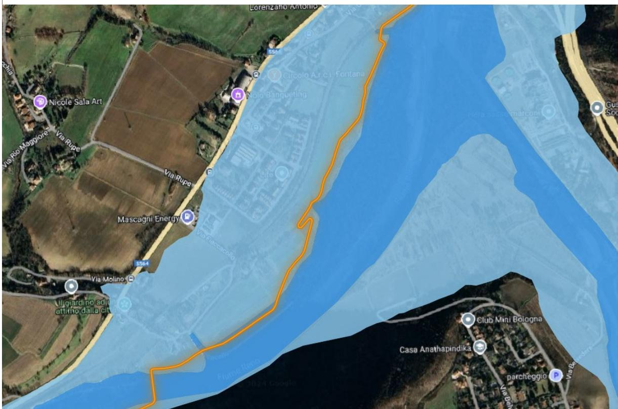
Figura 3 Sovrapposizione del tracciato alle aree di pericolosità del PGRA in corrispondenza della frazione di Fontana
