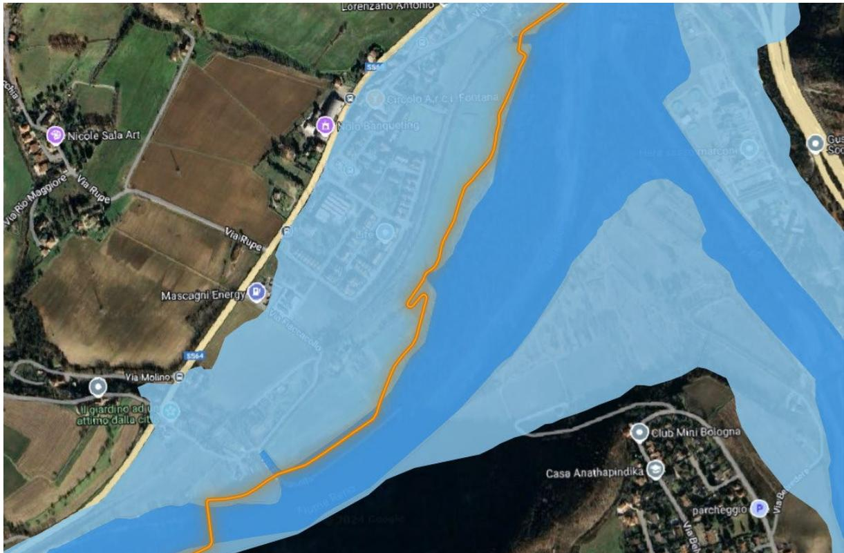
Figura 2 Sovrapposizione del tracciato alle aree di pericolosità del PGRA in corrispondenza della frazione di Fontana
