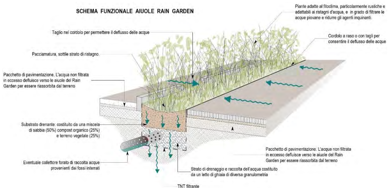
FIGURA 6.2.3 - SCHEMA FUNZIONALE DEL RAIN GARDEN.
