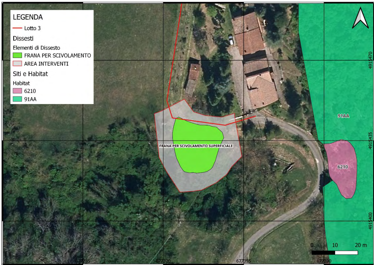
FIGURA 2.5.3.2 - AREA DI INTERVENTO DELLA FRANA PER SCIVOLAMENTO.
