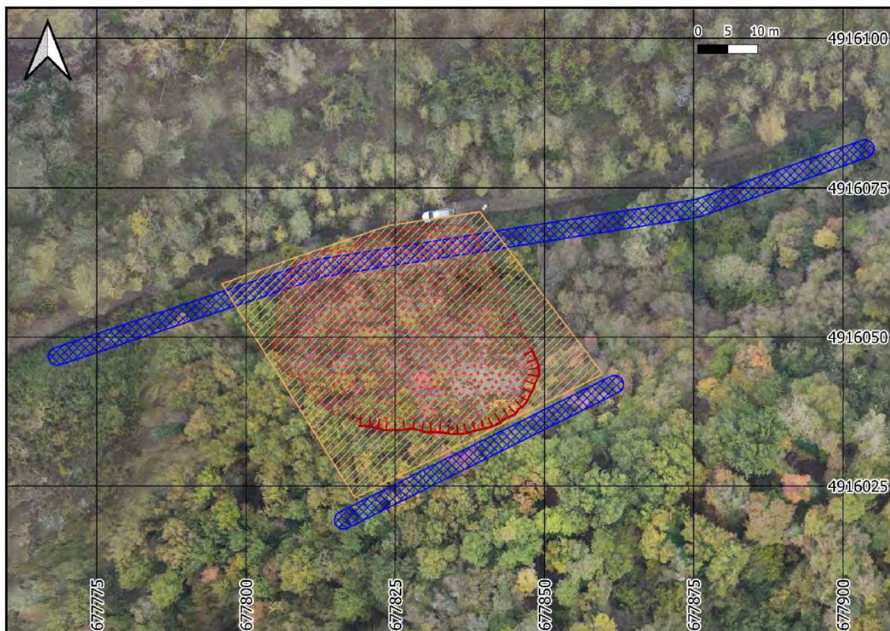
FIGURA 2.4.4.5 - OPERE DI MESSA IN SICUREZZA.
