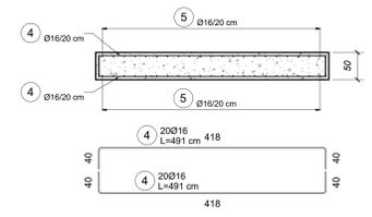
Sezione RA1: Rampa sp.50 - Armatura tipica
