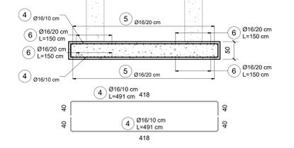
Sezione RA2: Rampa sp.50 - Armatura in corrispondenza dei pilastri
