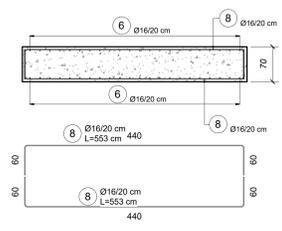
Sezione RA3: Rampa sp.70 - Armatura tipica
