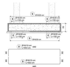
Sezione RA4: Rampa sp.70 - Armatura in corrispondenza dei pilastri
