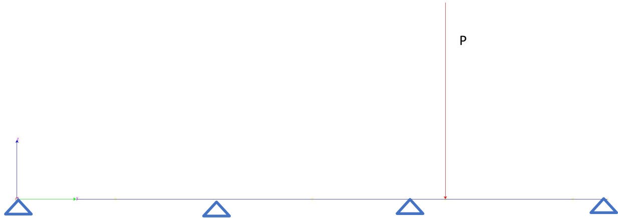
Ruota in a x = 0.44\text{m} dall'appoggio ( \rightarrow impronta B' esterna all'ala profilo) – Schema statico
