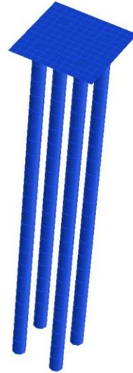
Figura 5-5 – Modello di calcolo agli elementi finiti (Spalla SX)
