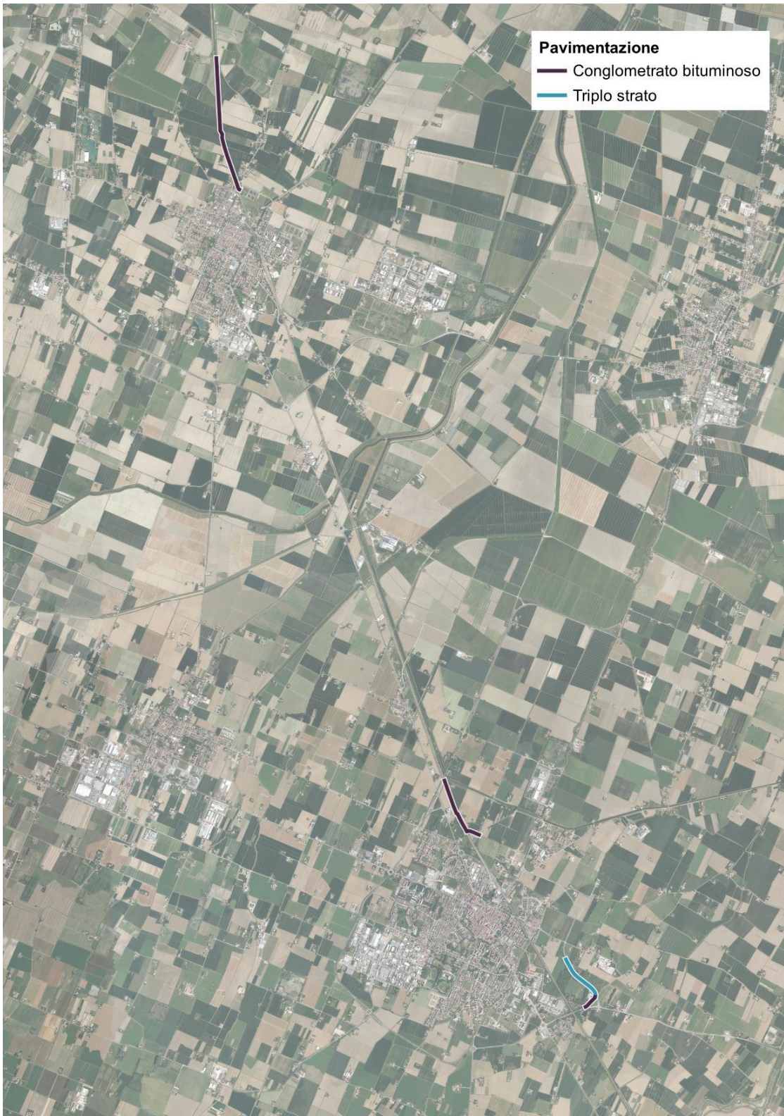
Figura 9. Pavimentazioni del lotto 1
