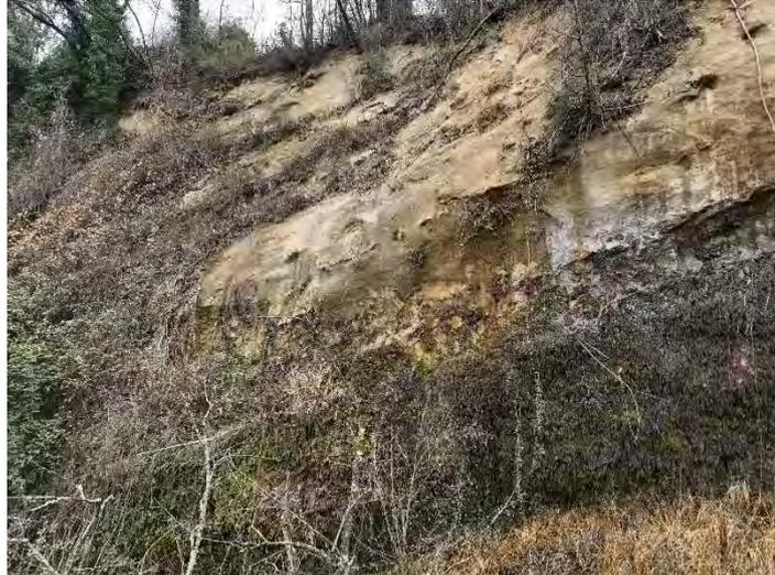
Dalle caratteristiche dell'affioramento sottostante l'attuale sede stradale, per la locale formazione arenitica, sono stati ricavati i seguenti dati giacitureali: Direzione strati: 127°; Immersione: 217° - SW; Inclinazione: 21°
