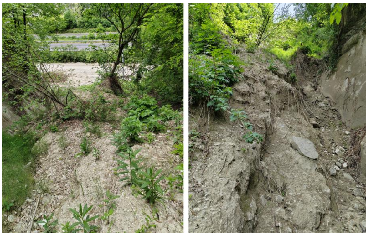
Figura 7-8. Il corpo della frana complessa (scivolamenti di coltre evolutisi in colata), denominato A_006, rimasto sospeso all'interno dell'incisione. Sulla sinistra viene ripreso da monte, sulla destra da valle.
