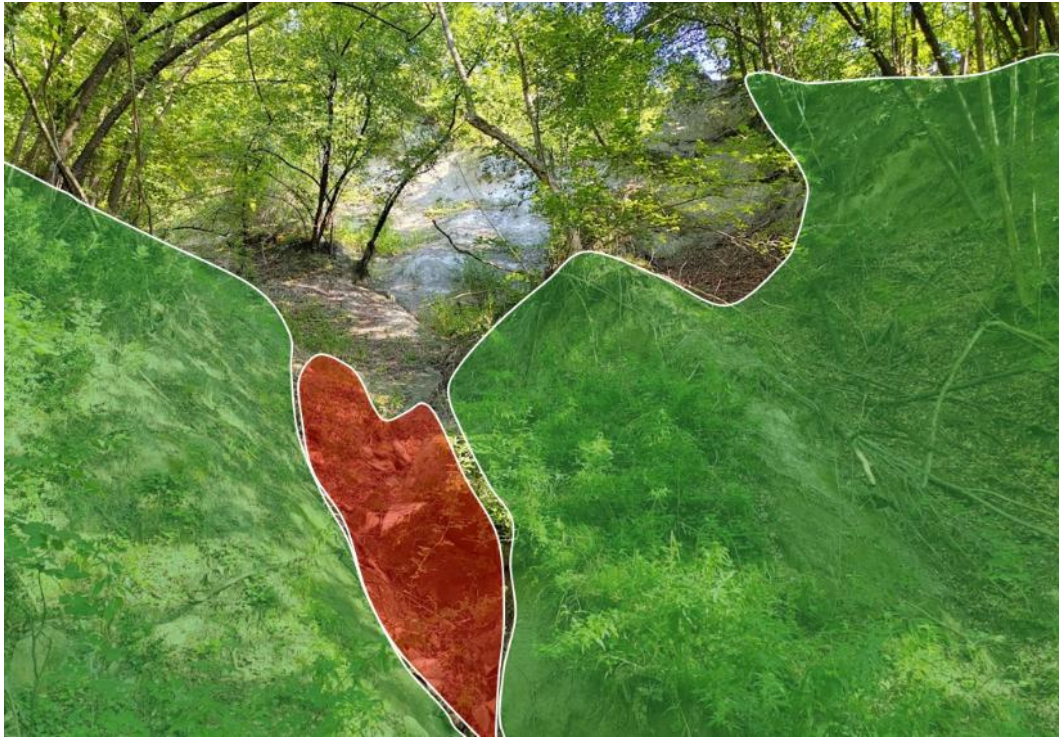
Figura 7-15. Schematizzazione dei depositi lungo un'incisione al piede di una parete rocciosa. In verde i depositi misti, a prevalenza eluvio colluviale, con inclusi lapidei in quantità variabile. In rosso coltri detritiche almeno parzialmente rimaneggiate dallo scorrere delle acque lungo il fondo canale. Più a monte il substrato affiora pressoché continuamente.
