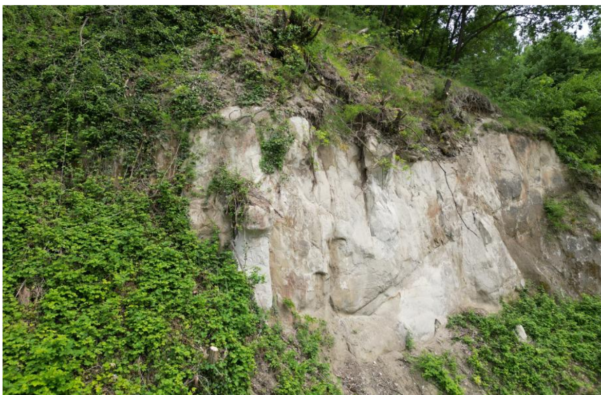
Figura 4-6. Ripresa aerea di un fronte roccioso nella parte centrale dell'area indagata. Qui più che altrove è possibile apprezzare la stratificazione a traverpoggio rispetto alla parete, e la presenza di fratture subverticali, più aperte nei pressi del ciglio, che predispongono a potenziali distacchi.
