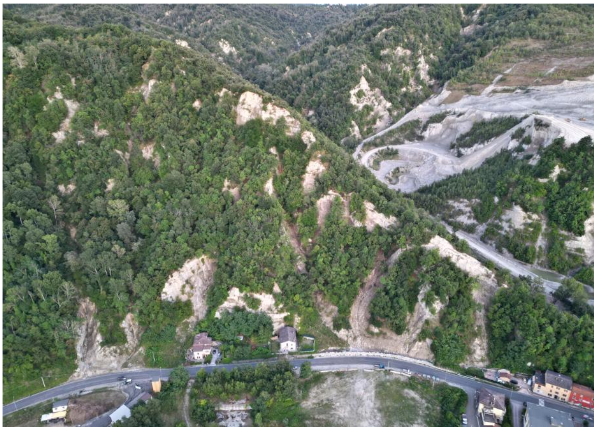
Figura 7-14. Ripresa aerea generale del versante a monte della SP 325 relativa al sito di Vado (1). Si notino le numerose incisioni seprata da pareti dorsali rocciose che ne costituiscono le testate ed i fianchi. Si notano diversi settori in cui la copertura boschiva è stata asportata dagli scivolamenti e dalle colate detritiche. In alcuni casi a rimanere esposto è direttamente il substrato (LOI), in altri casi permangono spessori di coltre ancora mobilizzabili o comunque erodibili.
