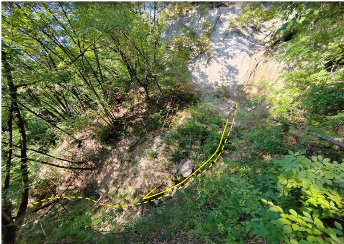
Figura 7-19. Esempio di coltre di genesi mista (detritica nella parte superiore e prevalentemente eluvio colluviale nella parte basale) poggianti sul substrato lungo il fianco di un'incisione al piede di una parete rocciosa. In occasione di eventi meteorologici particolarmente significativi, l'azione combinata delle sovrappressioni all'interno del materiale, dello scalzamento del piede a causa dell'erosione delle acque di ruscellamento e l'instaurarsi di un flusso al contatto coltre/substrato, possono mobilizzare in parte o del tutto il deposito. Un suo scivolamento può poi evolvere alimentando una colata detritica.
