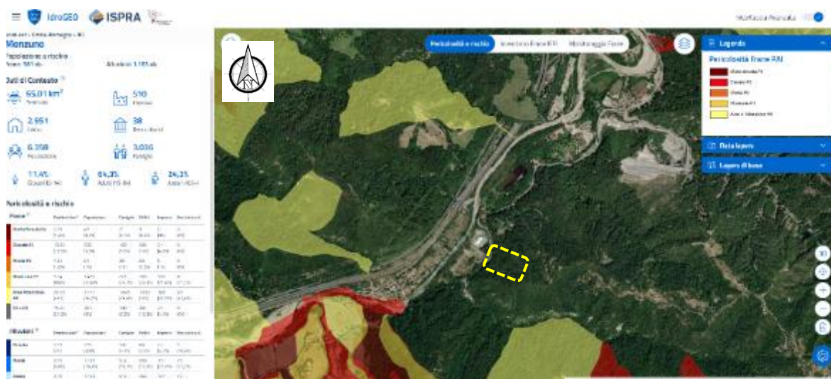
Figura 5-10. Estratto modificato dal Webgis disponibile sul sito del Portale IdroGEO di ISPRA ( https://idrogeo.isprambiente.it/app/pir/c/37044?@=44.30235523171518,11.249088392525316,17 ) che definisce il livello di pericolosità da frana all'interno dell'area di studio (tratteggio giallo) non viene indicata alcuna pericolosità da frana.
