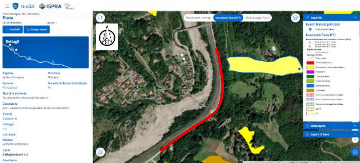
Figura 5-1. Cartografia dell'Inventario dei Fenomeni Franosi Italiani (IFFI), a cura dell'ISPRA (scala grafica). Nei pressi della tratta stradale oggetto di studio (linea rossa) non sono cartografate frane che raggiungano la viabilità. Si segnala la presenza di una frana per scivolamento rotazionale/traslattivo (ID: 0370926300), con stato di attività classificato “quiescente”, che discende dal versante sino a lambire il ciglio della scarpata stradale.
