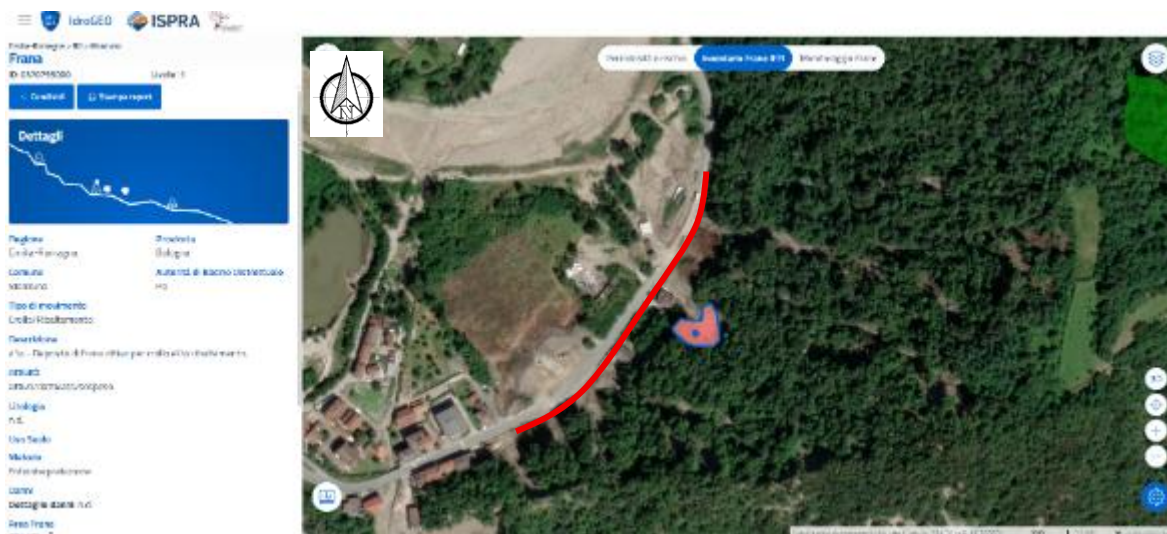
Figura 5-5. Cartografia dell'Inventario dei Fenomeni Franosi Italiani (IFFI), a cura dell'ISPRA (scala grafica). Nei pressi della tratta stradale oggetto di studio (linea rossa) non sono cartografate frane che raggiungano la viabilità. Si segnala la presenza di una frana per crollo/ribaltamento (ID: 0370795000), con stato di attività classificato "attivo/riattivato/sospeso", che si imposta lungo la parete a monte di una civile abitazione nella parte centrale dell'area di studio.
