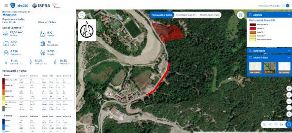
Figura 5-6. Estratto modificato dal Webgis disponibile sul sito del Portale IdroGEO di ISPRA ( https://idrogeo.isprambiente.it/app/pir/c/37036?@=44.3101017708793,11.262245374574784,19 ) che definisce il livello di pericolosità da frana. Lungo la tratta stradale attenzionata e le sue pertinenze non viene indicata alcuna pericolosità da frana).
