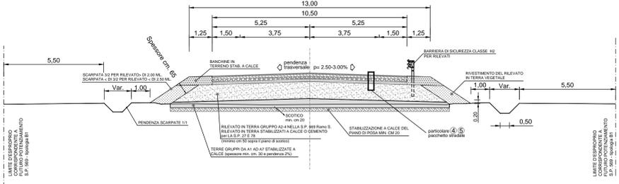
SEZIONE TIPO IN SCAVO ROTATORIA S.P. 27
