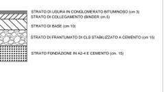
PARTICOLARE 2 Pavimentazione e fondazione rampe di svincolo ed S.P. 27 in scavo
