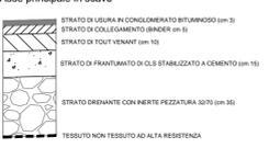
PARTICOLARE 4 Pavimentazione e fondazione S.P. 569 in rilevato
