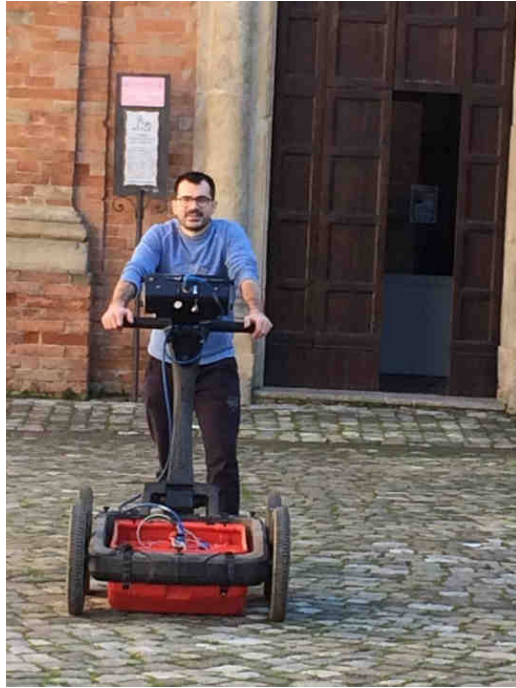
Figura 2 Georadar SIR 3000 utilizzato. (immagine di repertorio)
