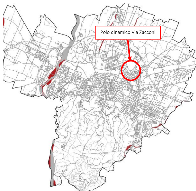
Figura 2-2: Aree ad alta probabilità di inondazione, \leq 50 anni (Fonte: scheda dei vincoli - Carta unica del territorio del Comune di Bologna)
