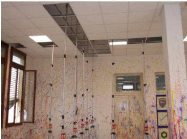
Foto 17 Posizione trasduttori prova di carico n°2
