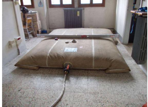
Foto 16 Carico massimo prova di carico n°1
