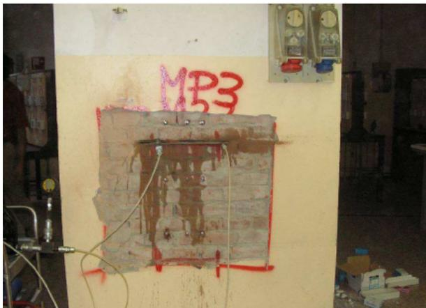
Foto 21 Prova Martinetti corpo ampliamento M3
