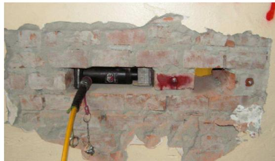
Foto 24 Prova a taglio ampliamento T3
