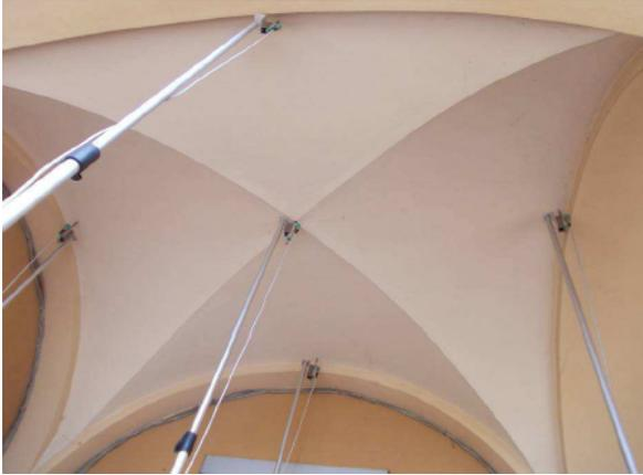
Foto 15 Posizione trasduttori prova di carico n°1
