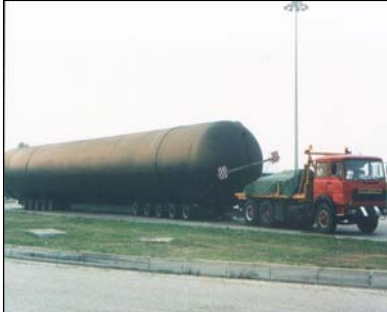
trasporto eccezionale di un silos
