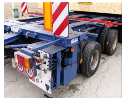
sistema idraulico per la regolazione dell' altezza da terra del carrello
