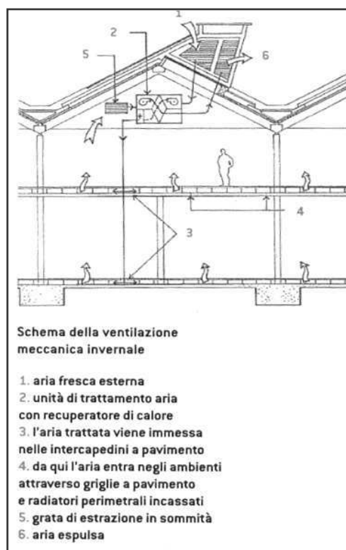
Fig. 30 - la nuova sede del National Trust a Swindon – Inghilterra - su progetto di Feilden Clegg Bradley Architects LLP, rivista Arketipo n. 5 di luglio-agosto 2006 – il funzionamento dei camini di vento.
