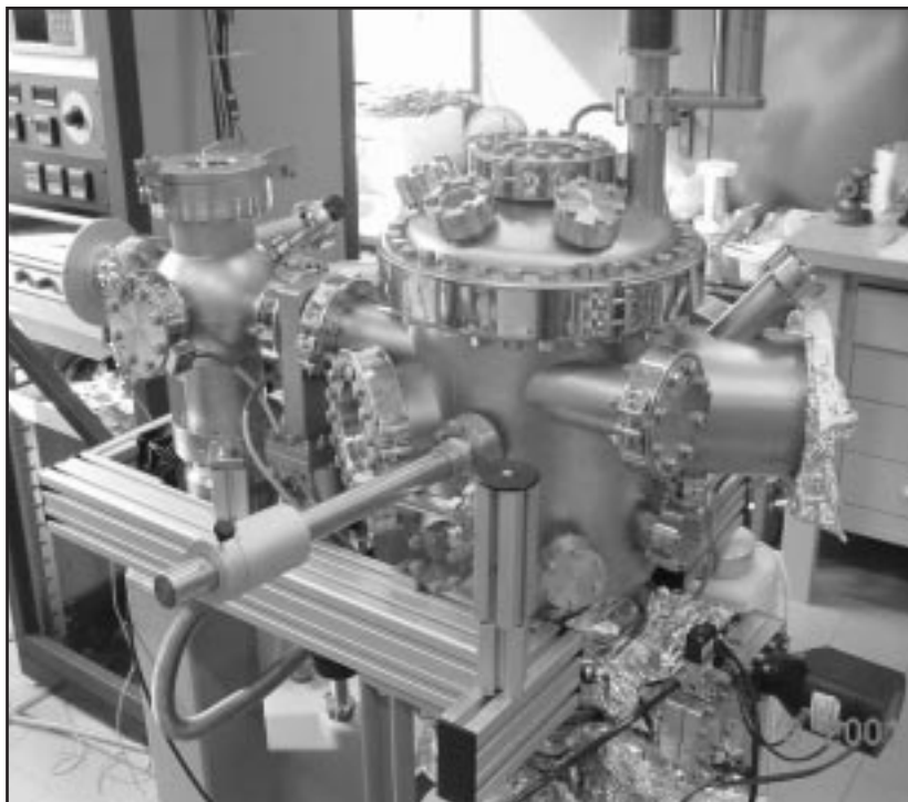
L'apparato per nanolitografia di materiali molecolari nel laboratorio Cnr-ISM di Bologna
