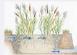
Sistema a flusso sommerso orizzontale (SFS - H o HF)
