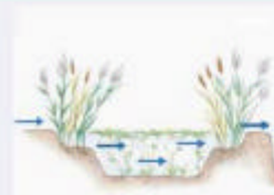
Sistema a flusso superficiale (FWS)
