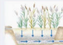
Sistema a flusso sommerso verticale (SFS - V o VF)
