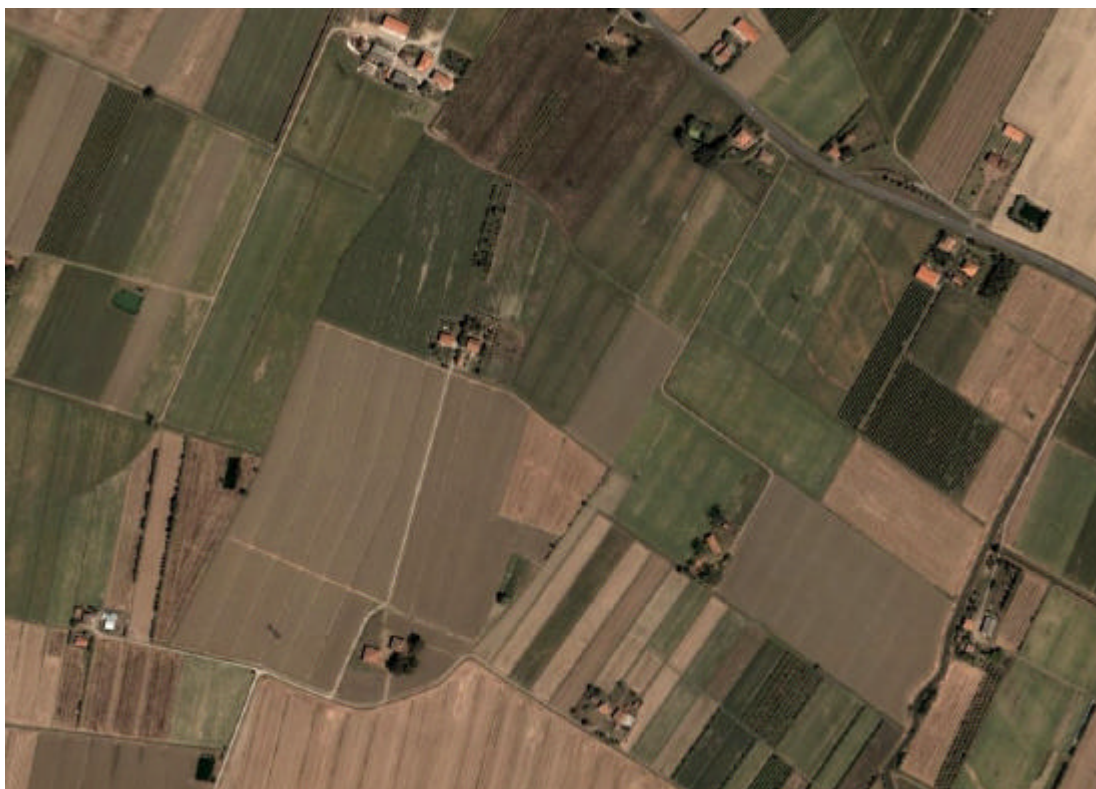
Figura 9: Tipico esempio di tessitura del territorio agricolo di pianura in Provincia di Bologna: appare evidente la presenza di campi rettangolari di ampia superficie, intercalati con elevata frequenza (interasse 30-40 ml) da scoline di drenaggio.
