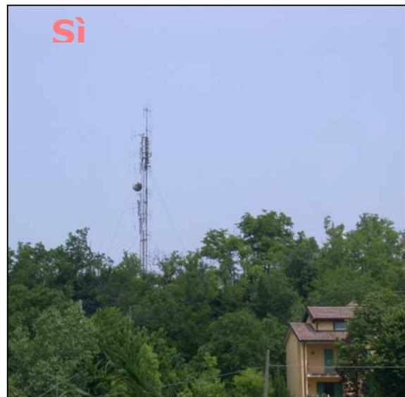
4. evitare situazioni in cui l'utilizzo di un sostegno esistente comporti la necessità di un suo eccessivo rinforzo o innalzamento, con conseguente significativo aumento dell'impatto paesaggistico;
