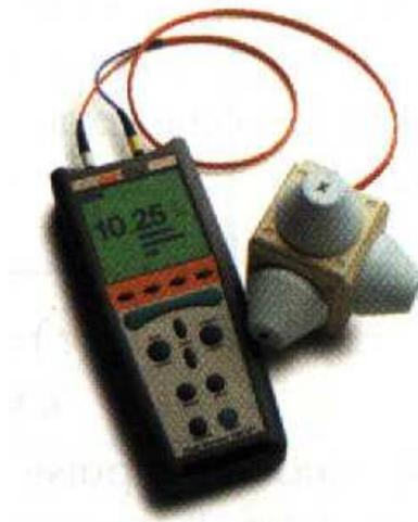
**fig. 2.3.3.1.a: misuratore di campo a banda larga**
