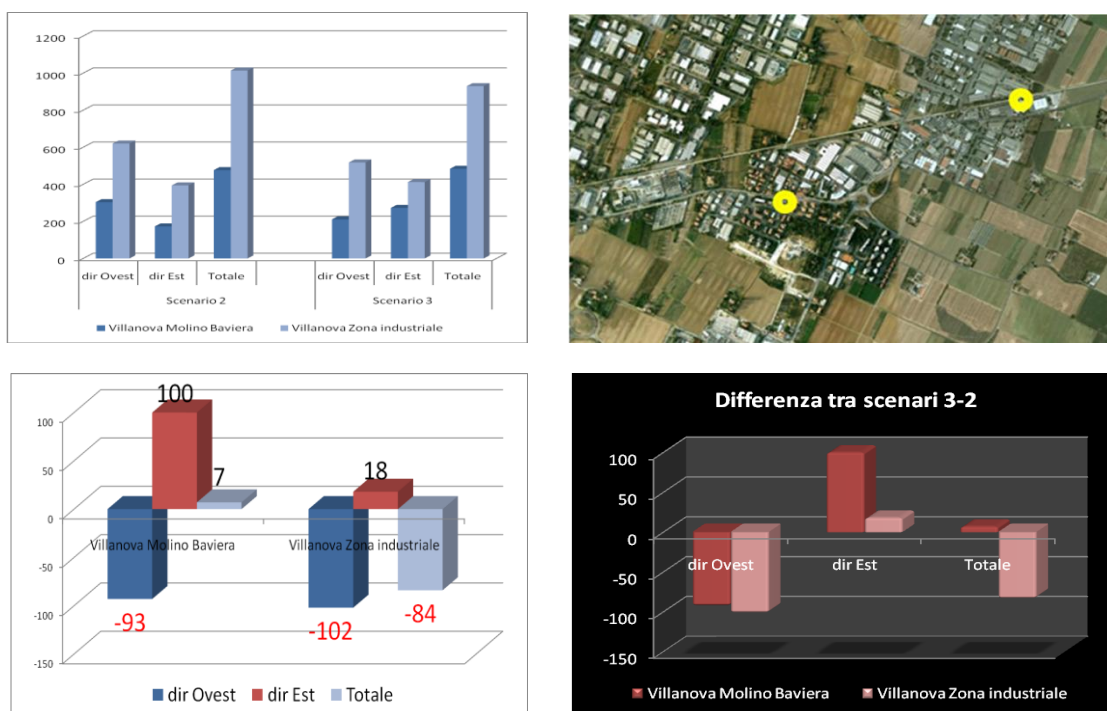
Graf. 5.1 - Confronto dei flussi di traffico in due sezioni di via Tosarelli a Villanova negli Scenari 2 e 3 (veicoli totali nell'ora di punta del mattino)
