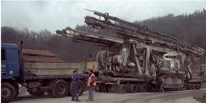
**Trasporto eccezionale:** lunghezza m. **34.00**; larghezza m. **4.60**; altezza m. **5.10** (m. **5.00** con abbassamento del carrello) e peso complessivo tonn. **114.53**; carico trasportato: **una perforatrice**.
